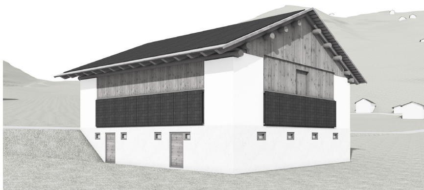
Impianti solari previsti per l'applicazione alla facciata; i pilastri d'angolo inseriti nella muratura esterna rappresentano degli elementi importanti che non possono essere interrotti
