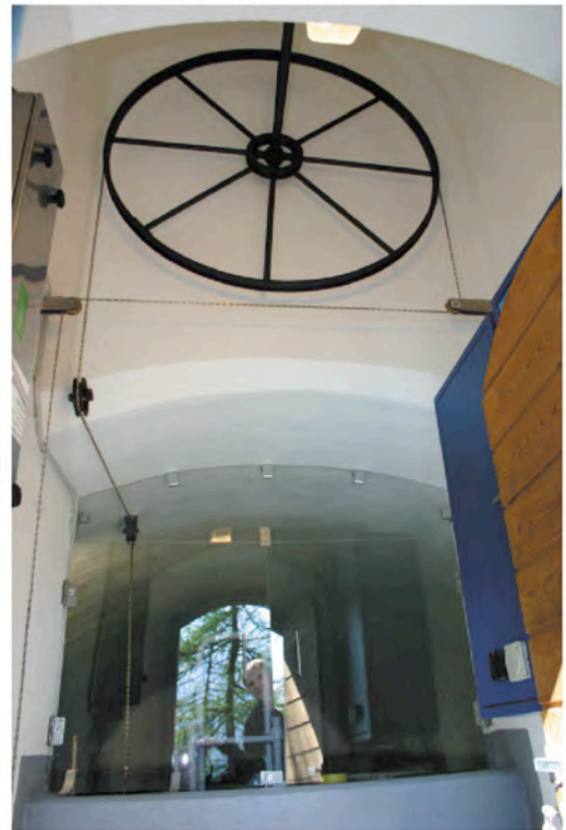
Abb. 656 : Mechanismus der Wasserstandsanzeige
