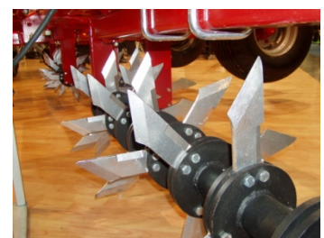
Bild 8: Stark verfilzte Wiesen- und Weideflächen werden durch diese Messer zerschnitten und damit Platz für Saatgut geschaffen. Allerdings bleibt der Konkurrenzdruck der noch bestehenden Grasnarbe gross (Evers).
