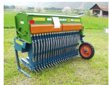
Bild 11: Der Herbamat sichert dem Saatgut guten Bodenkontakt.
