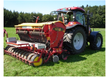
Bild 9: Direktsaatmaschinen eignen sich gut für Wiesenverbesserungen. Sie schaffen die Voraussetzungen für Keimbedingungen der Übersaatmischung.
