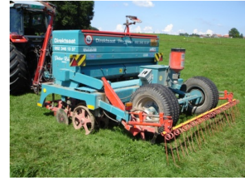
Bild 4: Spezialmaschine bestehend aus Sämaschine und einer nachfolgenden Egge. Geeignet für schwierigere Situationen.
