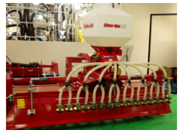
Bild 10: Die Kombination von Rotoregge und Sägerät eignet sich für Flickarbeit auf kleinen Flächen.
