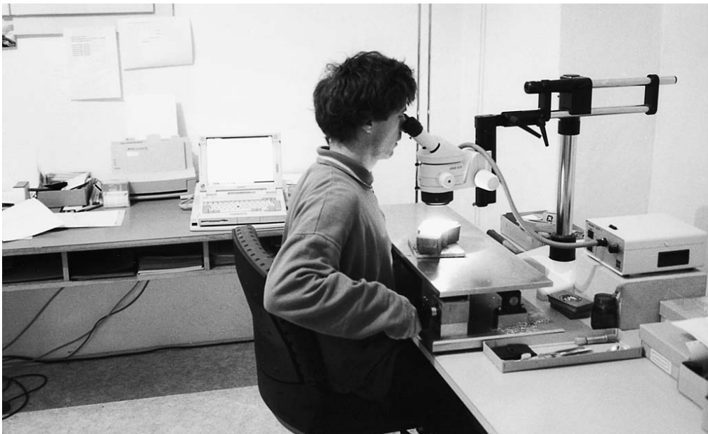
Abb. 66: Die Anlage zur dendrochronologischen Untersuchung von Holzproben im ADG. Im Vordergrund der Messtisch, auf dem die Jahrringe der Holzproben unter der Stereolupe ausgemessen werden. Die Werte werden direkt über ein am Tisch angeschlossene Messschiene in den Computer zur weiteren Verarbeitung übertragen.
