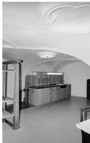
Abb. 19+20: Die neu gestal- tete Küche im 1. Oberge- schoss mit dem neuen Schiebetürabschluss zum Treppenhaus. Die freie Auf- stellung der Küchenelemen- te in der ursprünglichen Gangnische unterstreicht die Grosszügigkeit des Grund- risses. Drei Materialien kamen zum Einsatz: Grauer Terrazzo, Buchenholz und geschliffener Chromstahl.
