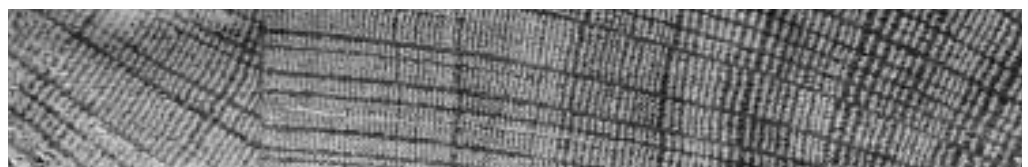
Abb. 55: Chur 1998, Kathedrale. Aufsicht auf die gereinigte und mit Kreide eingeriebene Stirnseite von zwei Brettern der Vorderwand in Reihe D. Deutlich erkennbar die engringige Jahrringabfolge. Mst. etwa 1:1.
