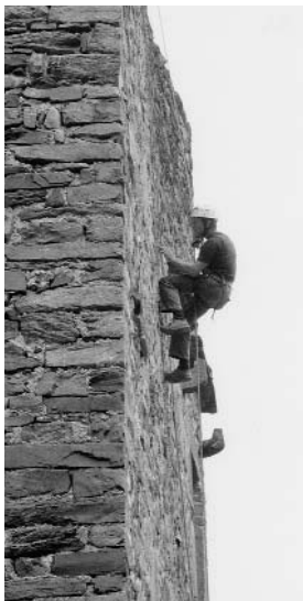
Abb. 2: Sils i. D., Burganlage Hohenrätien. Mathias Seifert bei der Holzprobenentnahme für die dendrochronologische Datierung.
