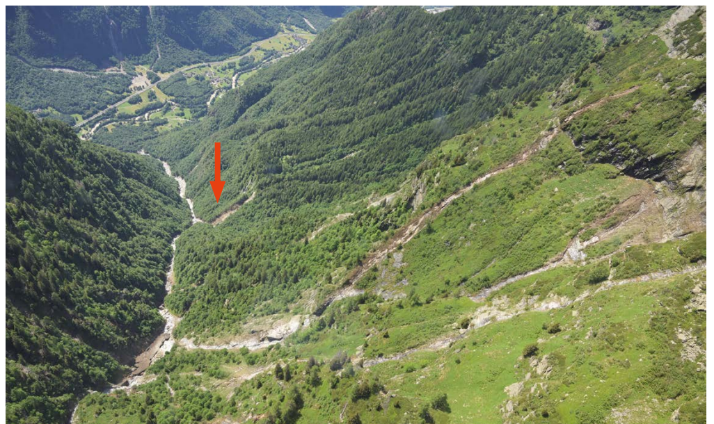
Abbildung 14: Blick ins obere Einzugsgebiet der Rià de la Molera (Lostallo) Runsen mit flachgründigen Hangprozessen, unten links die Altschneeablagerung, roter Pfeil zeigt das Nebengerinne (Quelle: Schrägaufnahme aus Rapid Mapping vom 28.6.2026 [1])
