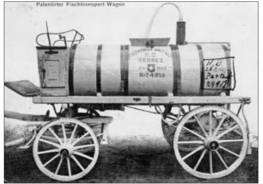
Dieses patentierte Gefährt diente früher zum Transport von lebenden Speisefischen vom Silsersee nach Zernez. Mit einer Pumpe wurde die Wasserzirkulation und damit der Sauerstoffeintrag gewährleistet. Bild zVg von Anton Klucker
