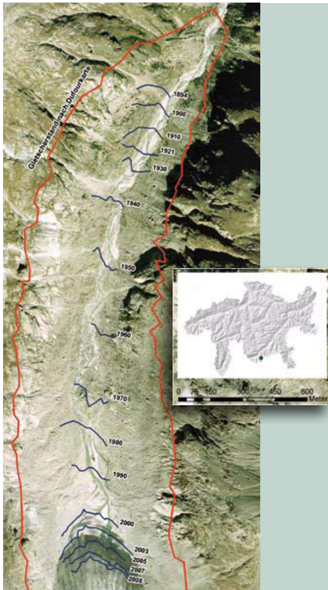
Entzerrte Luftaufnahme (Orthofoto) vom Vorfeld des Vadret del Forno mit einer Auswahl der jährlich vermessen Ausdehnung der Gletscherzunge. Die rote Umrandung entspricht dem Gletscherstand 1852.
