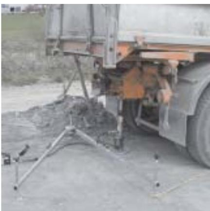
Kontrolle der Verdichtung des Strassenkoffers auf der Baustelle mit dem Plattendruckversuch
