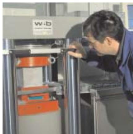
Standardprüfung der Druckfestigkeit an einem normierten Betonwürfel mit der Kantenlänge 150 mm
