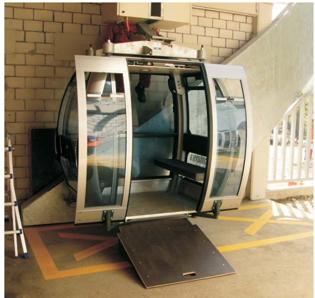
La nuova cabina accessibile alle sedie a rotelle della funivia da Selma a Landarenca. Rollstuhlgängige neue Kabine der Bahn von Selma nach Landarenca.
