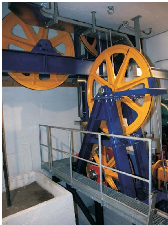
La trasmissione del motore. Das Räderwerk des Antriebs.
