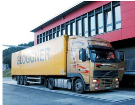
Auf der zweiteiligen Brückenwaage werden allfällige Gewichtsübertretungen mit einer Genauigkeit von 20 kg gemessen.
