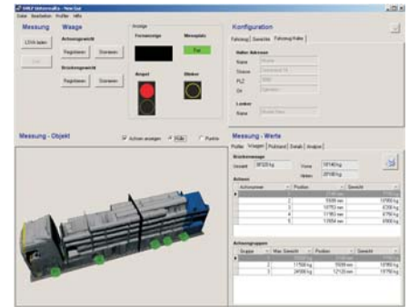
Die Resultate der Masskontrolle der Fahrzeuge werden im System ausgewertet und am Bildschirm dargestellt.
