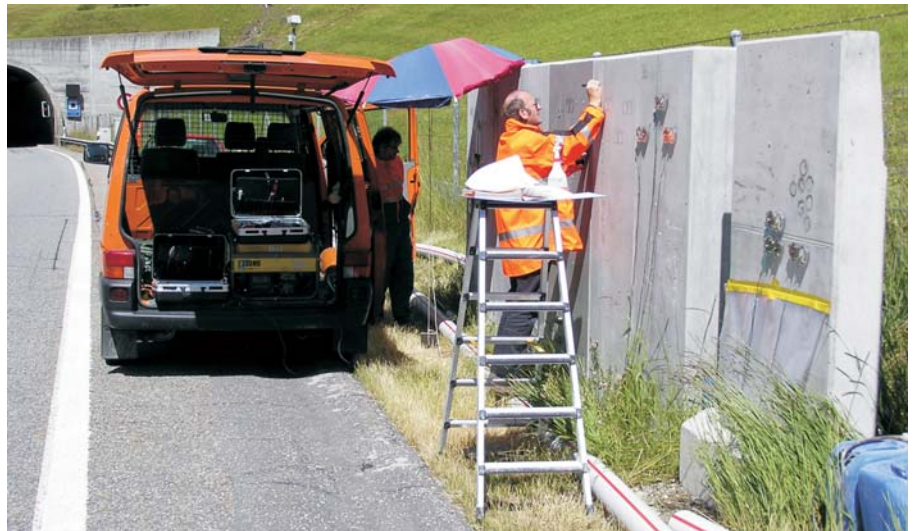
Untersuchungen an verschiedenen Oberflächenschutzsystemen, aufgebracht an Probewänden, A13 Cassanawald
