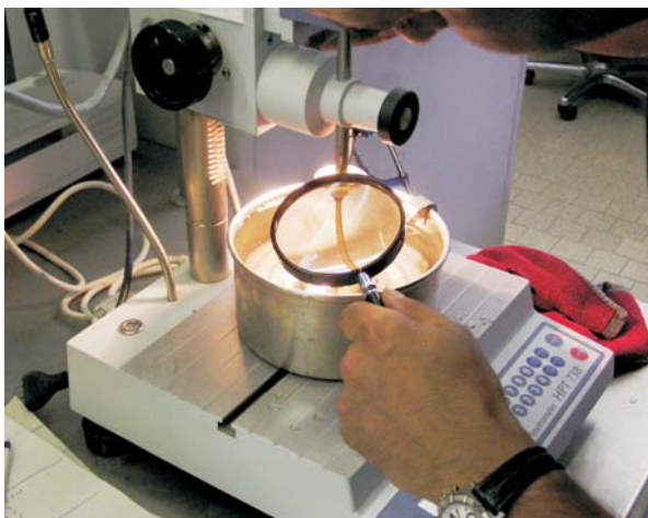
Feinarbeit bei der Bestimmung der Nadelpenetration, akkreditierte Laborprüfung des Strassenbaulabors
