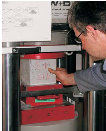
Akkreditierte Prüfung der Druckfestigkeit, ausgeführt an normierten Betonwürfeln mit Kantenlänge 150 mm.
