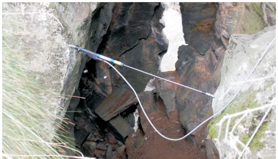
Elektronische Überwachung von Felsbewegungen, A13 Brusei
