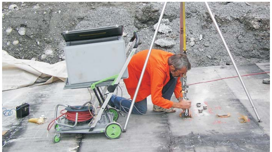
Im Strassenbaulabor entwickeltes Schälzuggerät für Prüfungen an Polymerbitumen-Dichtungsbahnen.
