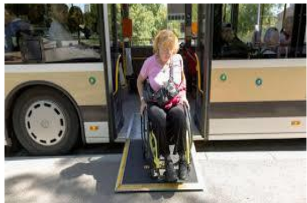
Haltekante mit Höhe 16 cm, damit Neigung der Klapprampe \leq 12\% (mit Hilfestellung max. 18\% )
