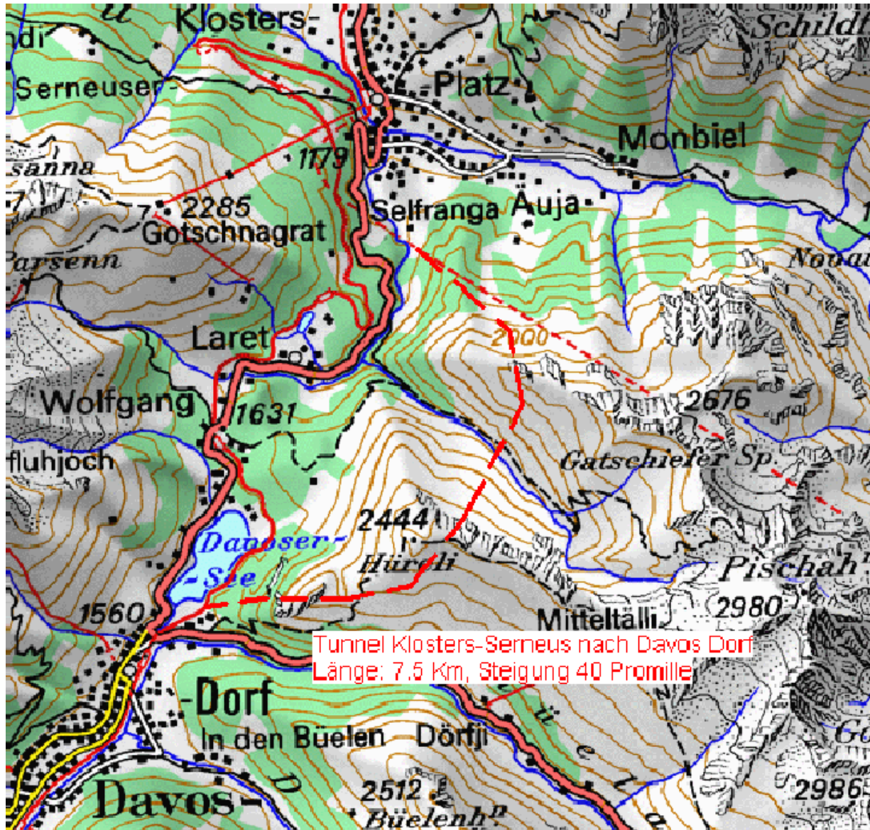
Anschlussstunnel Selfranga - Davos Dorf (Rhätische Bahn: Angebotskonzept „NEVA Retica Plus“ und notwendige Investitionsmodule, Anhang, Modul 5, Juli 2001)
