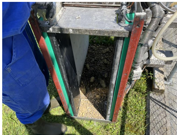
Abb. 2: Scannerplatten nach Verringerung des Abstands auf 30 cm, am 23.07.2024
