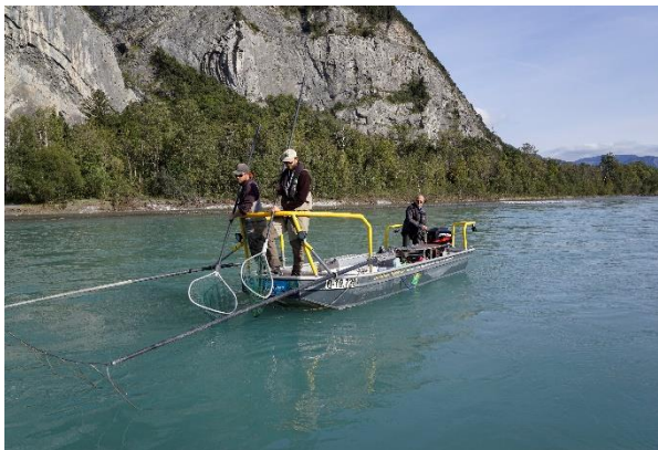
Abb. 5.1: Großes Elektrofangboot - Rechen (© ezb TB Zauner)
