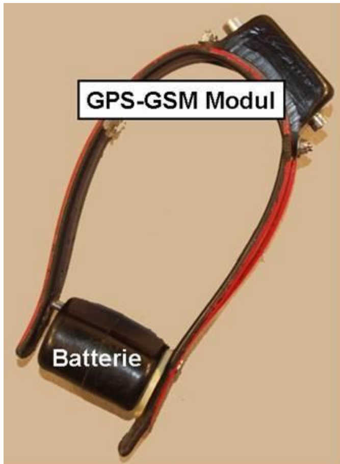
Abbildung 2: Hauptbestandteile des GPS- GSM Halsbandsender.
