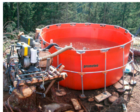
Mobile Wasserentnahmestelle mit Motorspritzpumpe für den Einsatz der Bodentruppen.
