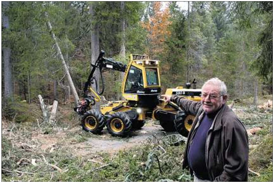
Das erste Glied in der Holzkette: Revierförster Thomas Färber erläutert im Flims Wald die Arbeitsweise des Prozessors bei der Holzernte. (Foto Theo Gstöhl)
