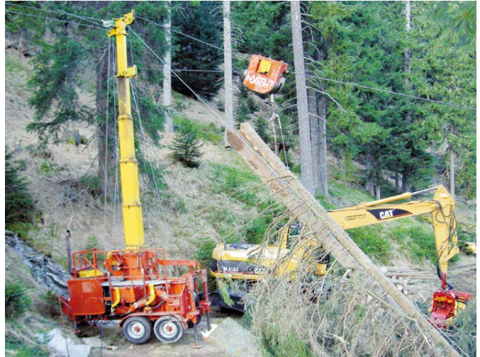
Das geschlagene Holz wird mit einem Seilkran an die Waldstrasse transportiert. Eine häufige Holzerntemethode im Gebirgskanton Graubünden.
