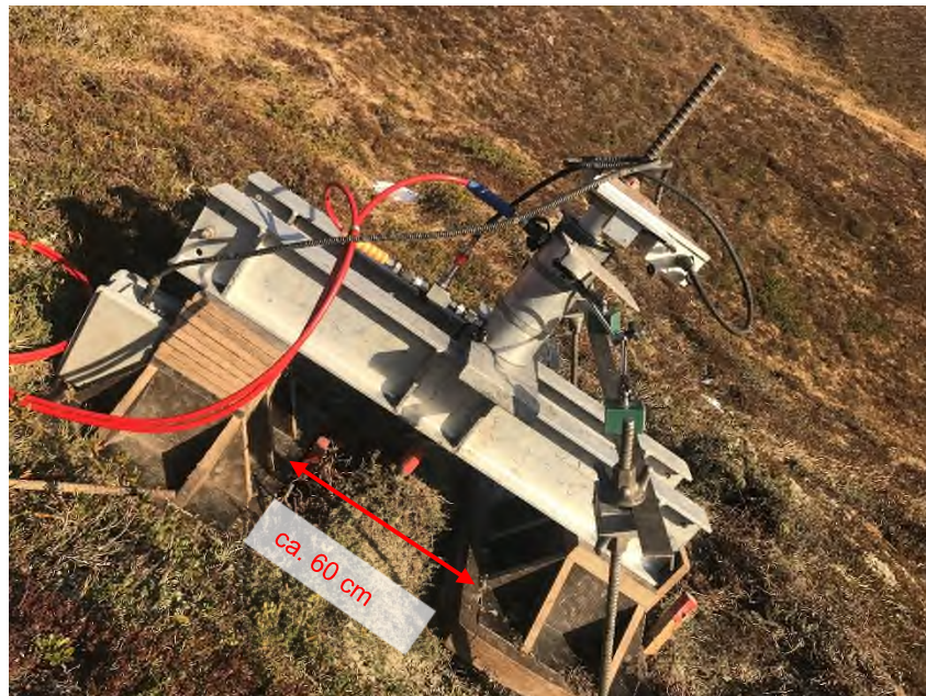
Abb. 5.1: Abstand der Widerlager (Foto: PA3)
