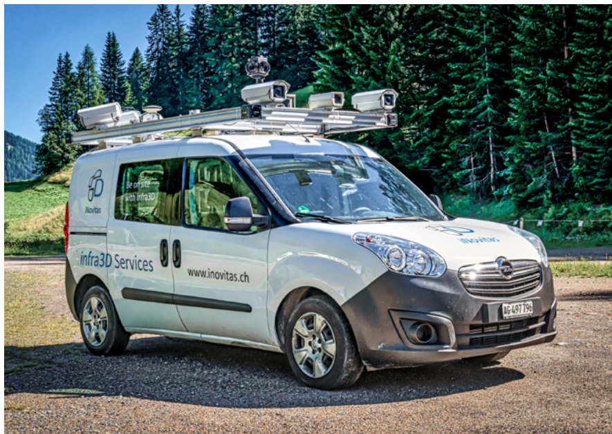
Mappatura mobile: veicolo di misurazione appositamente equipaggiato della iNovitas AG.
