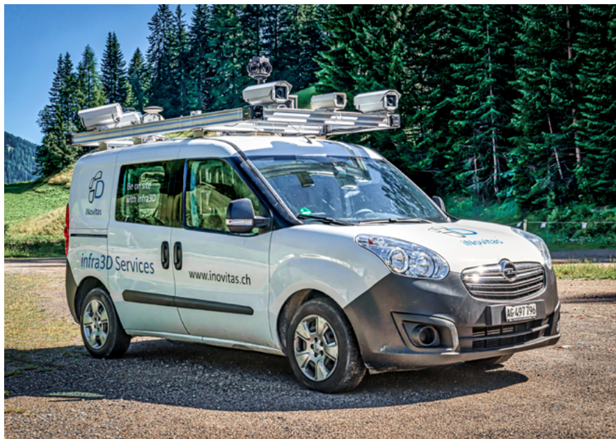
Mapping mobil: vehichel da mesiraziun equipà spezialmain da la iNovitas SA.
