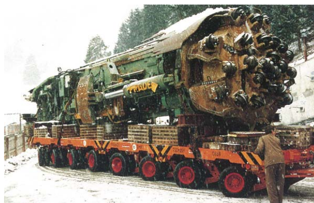
Tunnelbohrmaschine für Pilotstollen Umfahrung Trin
