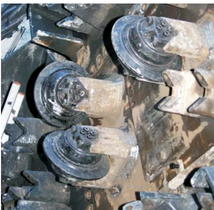
Der Druck solcher Rollenmeissel bricht den Felsen Stückchen für Stückchen aus der Stollenbrust.
