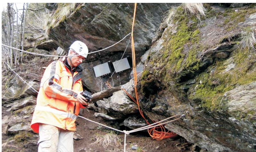
Kontrolle der Verschiebungen mit elektronischen Messgeräten Controllo dei movimenti con strumenti di misurazione elettronica
