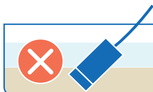
Figura 2: Installazione della pompa, la pompa non deve trovarsi nel fango
