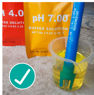
Calibrazione della sonda pH
