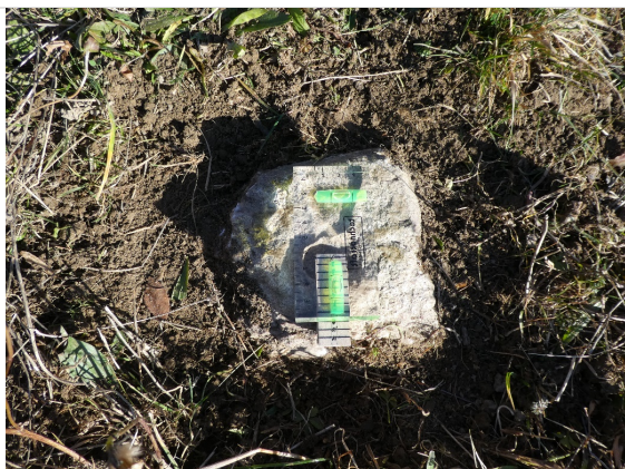
Abb. 3 Messkeil unterlegen, bis Wasserwaage horizontal
