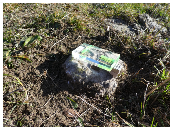
Abb. 4 Seitenansicht Messkeil (Ablesung Abstich)
