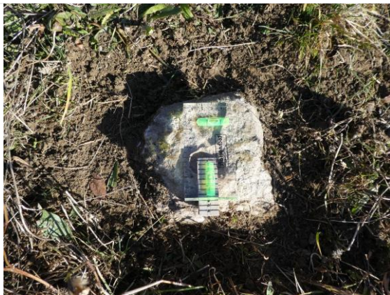
Illustraziun 3 Metter suten in cugn, fin ch'il nivel è orizzontal
