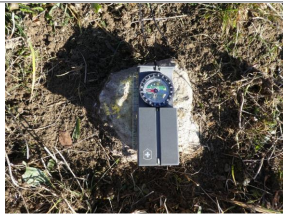
Illustraziun 2 Mesirar l'acimut en direcziun dal center teoretic
