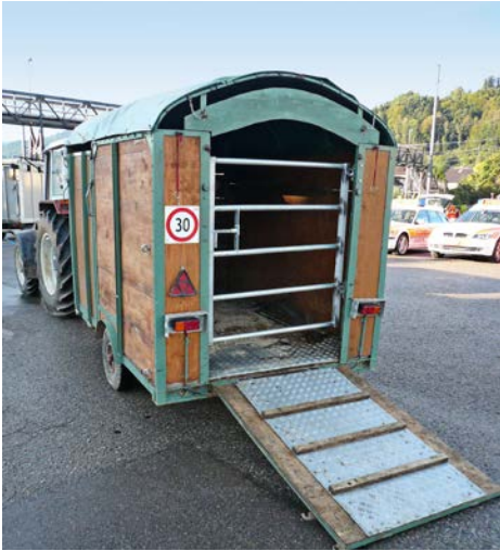
Landwirtschaftlicher Anhänger mit korrekter Rampe und Abschlussgitter.
