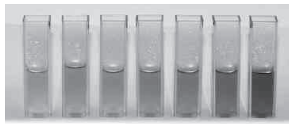
Abb. 4.10.2 Photometrischer Nachweis von Hydroxyprolin. Dargestellt ist die chemische Färbungsreaktion und das farbige Kondensationsprodukt in Küvetten. Je intensiver die Rotfärbung (dunkler), desto mehr Hydroxyprolin ist in der Lösung enthalten. (Bildquelle: Universitätsklinikum Giessen).
