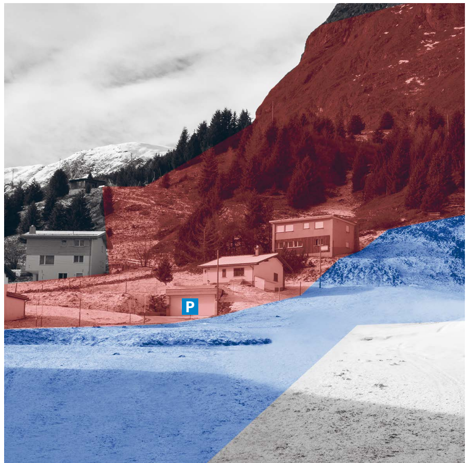
Bivio: se vengono rispettate determinate disposizioni, le costruzioni annesse o accessorie a edifici abitativi possono trovarsi nella zona di pericolo 1 (rosso) (qui: sostituzione parcheggio in superficie tramite garage sotterraneo). (processo: valanga) (foto: M. Bär, UST-GR)
