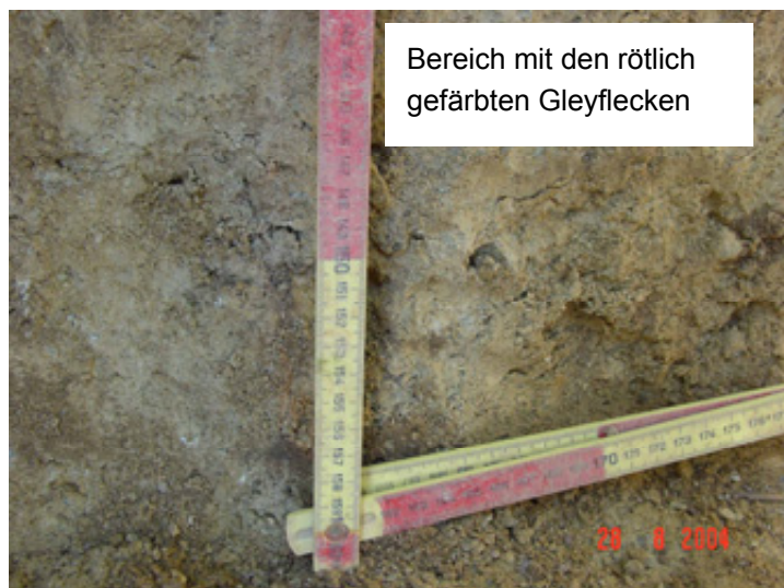
Abbildung 8: Gleyflecken als Hinweis auf einen Interflow im Bereich des BC- und C- Horizontes (bei Bodenprofil 6)
