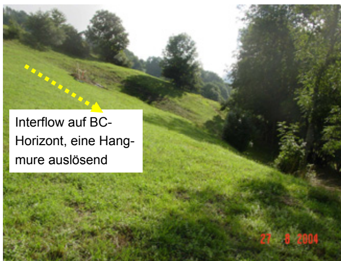
Abbildung 13: Situation unterhalb von P1: Steilböschung unterhalb der Hangterrasse mit Anrissbereich der Hangmure.
