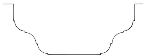
Abb. 66 Susauna, Haus 220. Balkenprofil der flachen spätgotischen Decke der Stube.
