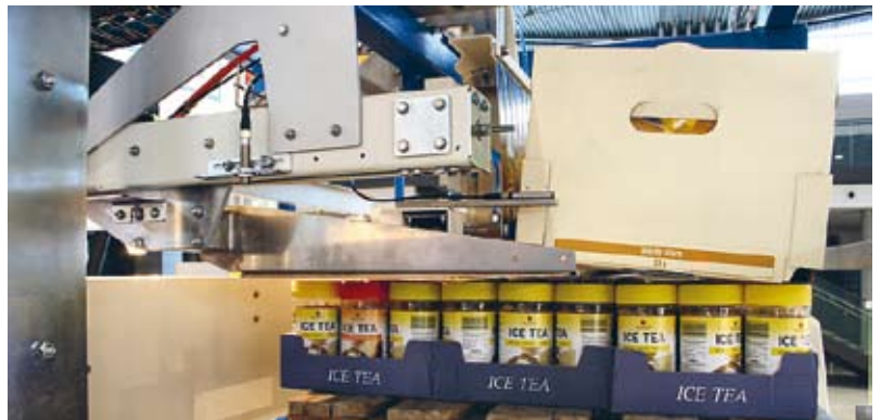
Unten: Entstapeln von schwierig handhabbaren Produkten
