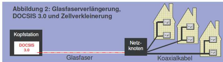
Abbildung 7 Verlängerung Glasfaserleitungen bis ins Quartier, ähnlich dem Netz von Swisscom AG mit VDSL (Quelle: Cablecom)
