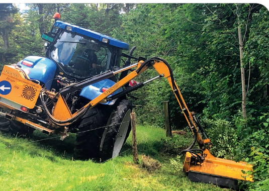
Die Verwendung von Doppelrädern verschiebt die Kipplinien und macht das Fahrzeug stabiler.
