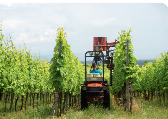
Erhöhte Kippgefahr durch eine schmale Standfläche, ein hoher Schwerpunkt und eine seitlich versetzte Maschine.
