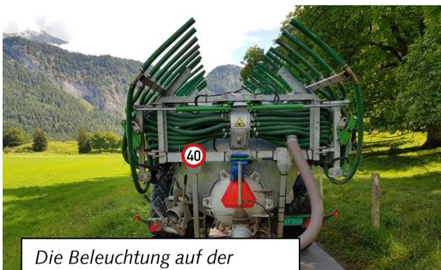
Die Beleuchtung auf der rechten Seite wird bei diesem Güllefass durch einen Schlauch abgedeckt.
