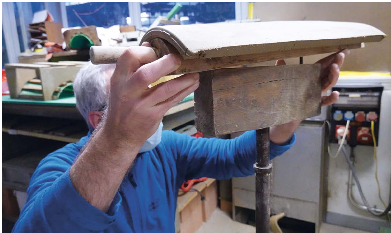
Abb. 5: Rapperswil BE, Ziegelwerk Gasser Ceramic AG. 2022. Für das einfachere Arbeiten sind die Holzleisten drehbar auf Ständern montiert.
