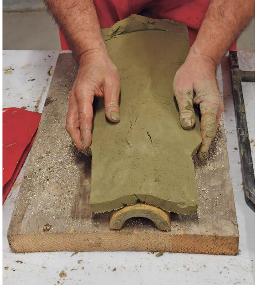
Abb. 4: Cham/Hagendorn ZG, Ziegelei-Museum. 2022. Formen des Ziegels auf dem Leisten. Im Bereich des Einzuges und dem Übergang zwischen dem breiten und schmalen Ziegelteil bilden sich deutliche Risse.
