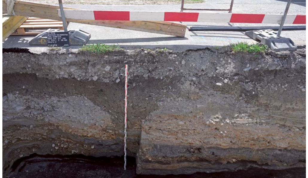
Abb. 4: Val Müstair. Müstair, Dorf. 2022. Auf einer dunklen torfähnlichen Schicht liegt eine Abfolge von Stillwasserablagerungen und Rüfenschichten im Kreuzungsbereich der Senda da Scuola und der Umfahrungsstrasse Via Prävis. Blick gegen Westen.
