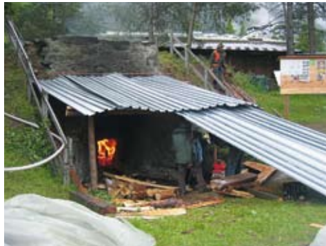
Abb. 121: Kalkkurs in Sent. Der Kalkofen in Funktion.
