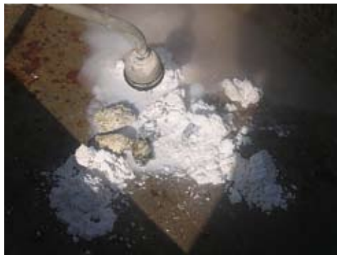
Abb. 123: Kalkkurs in Sent. Löschen des Kalks.
