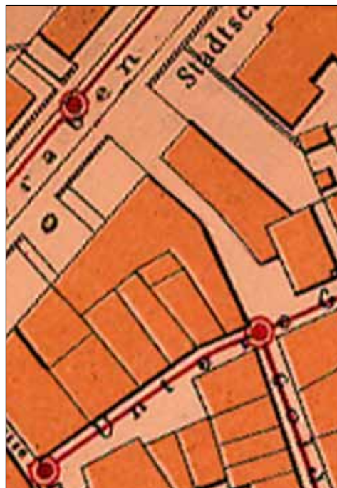
Abb. 76: Chur, Goldgasse/Grabenstrasse. Ausschnitt des Stadtplans von Ernst Karl Münster aus dem Jahr 1876, nachgeführt von Emil Blumer im Jahr 1891. Mit roter Farbe eingezeichnet ein erst 1907 ausgeführtes Kanalisationsprojekt aus dem Jahr 1889. Mst. 1:1000.
