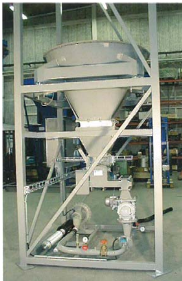
Abbildung 6: Links: Big Bag-Entleerer mit Seitenkanalgebläse zur pneumatischen Förderung von pulverförmigen Materialien. Rechts: Multischneckendosierer zur Dosierung von pulverförmigen Materialien. Beides sind Produkte der Firma Tomal AB (Teil der ProMinent Gruppe)
