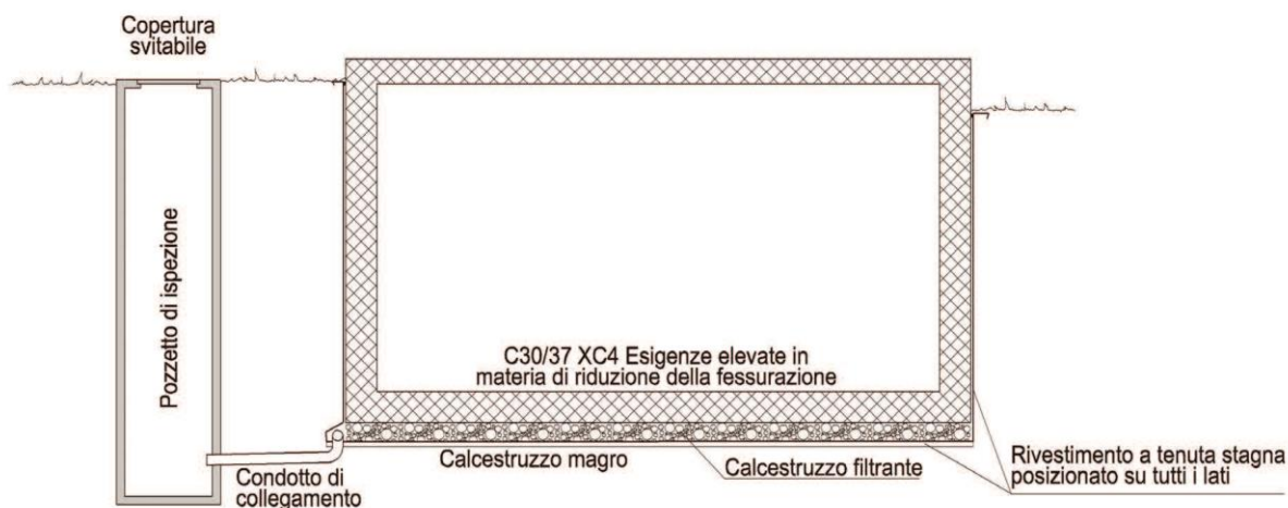
Fig. 1: Esempio di serbatoio del colaticcio con sistema di rilevamento di perdite con rivestimento continuo a tenuta stagna
