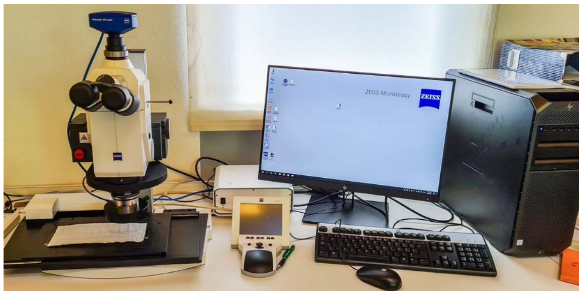
Figura 2: il nuovo microscopio Axio Zoom.V16 della Zeiss offre alla SUPSI un'ulteriore possibilità per verificare se sui bastoncini di legno siano presenti uova di zanzara tigre. (fotografia: SUPSI, 2020)
