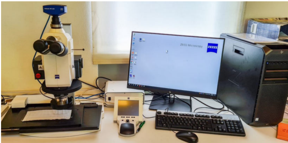
Abbildung 3: Das neue Mikroskop Axio Zoom.V16 von Zeiss bietet der SUPSI eine weitere Möglichkeit, die Holzstäbchen auf die Präsenz der Tigermückeneier zu untersuchen. (Aufnahme: SUPSI, 2020)
