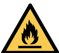
Attenzione: materiale infiammabile
