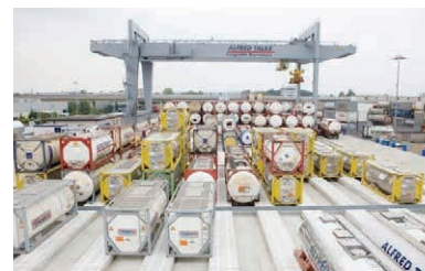
Stato della tecnica in materia di stoccaggio di cisterne : Vasca di contenimento e terminal di cisterne (azienda TALKE presso Hürth, Colonia).
