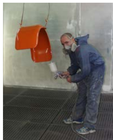
Die Abluft aus Spritzkabinen muss über eine Filteranlage gereinigt werden.
