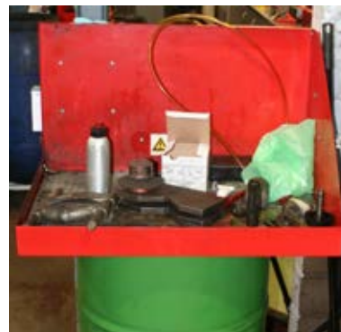
Kleinteilereiniger: Klappdeckel, die bei Nichtbetrieb geschlossen werden.
