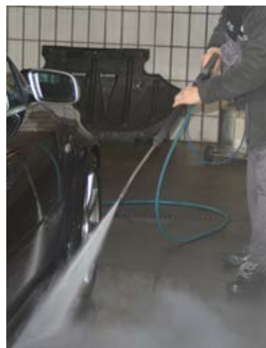
Die Reinigung mit einer Hochdrucklanze spart Wasser.
