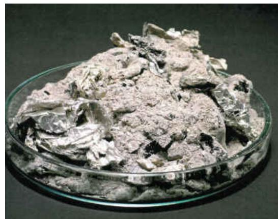
Bruciando anche rifiuti domestici, nel residuo non completamente incenerito rimangono pezzettini di metallo, pellicole di alluminio, "residui di plastica", etc. Conseguenti tracce restano visibili anche sulle pareti delle stufe e delle canne fumarie: forte annerimento da fuliggine, erosione delle pietre e altri danni da corrosione, schegge di materia plastica fusa.
